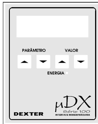
Pode-se modificar e/ou visualizar temporizadores, variáveis e constantes do programa no controlador μDX. Além disso, a interface possui 8 entradas analógicas de 0 a 5 V (resolução de 8 bits), possibilitando medir variáveis como temperatura, por exemplo (mediante sensor com saída padrão 0 a 5V).
