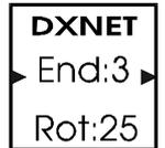
Este é o bloco de instrução que permite a intercomunicação com vários μDX utilizando-se a Rede Local DXNET.
