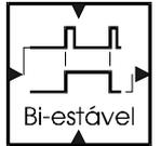
Este bloco reproduz a função de um multi vibrador biestável ("Flip/Flop") que troca o estado do nodo de saída cada vez que o nodo de entrada passa do estado de desligado para ligado.
