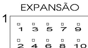
Serve para conectar ao μDX algum circuito externo para a entrada e saída de dados de 8 bits ou para controle direto de um display e/ou teclado (ver ANEXO C - Diagramas Esquemáticos).
