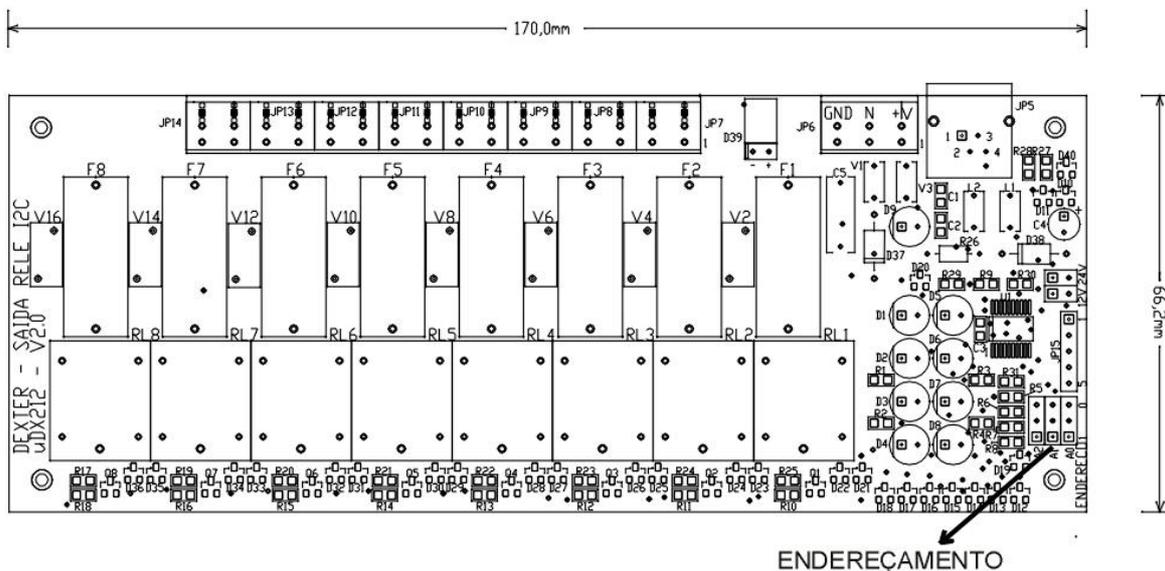
O endereço do  $\mu$ DX212 é determinado pelos jumpers existentes no conector ENDEREÇO, sendo que a posição superior é nível 0 e a posição inferior é nível 1. Note que o  $\mu$ DX212 é fornecido com os três jumpers de endereçamento nonível zero, ou seja, ocupando o endereço de módulo 0. Assim, temos:
