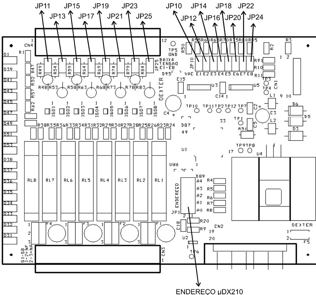
O endereço do  $\mu$ DX211 é determinado pelos jumpers existentes no conector ENDEREÇO, sendo que jumper aberto significa nível 0 e jumper fechado nível 1. Note que o  $\mu$ DX211 é fornecido com os cinco jumpers de endereçamento abertos, ou seja, ocupando o endereço de módulo 1. Assim, temos:
