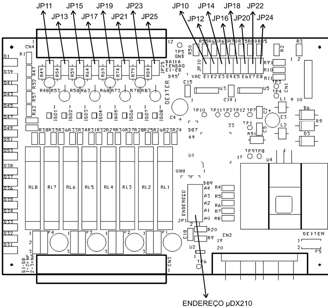
O endereço do  $\mu$ DX210 é determinado pelos jumpers existentes no conector ENDEREÇO, sendo que jumper aberto significa nível 0 e jumper fechado nível 1. Note que o  $\mu$ DX210 é fornecido com os cinco jumpers de endereçamento abertos, ou seja, ocupando o endereço de módulo 1. Assim, temos:
