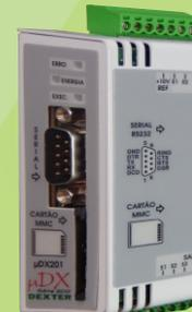
Parte frontal com LEDs indicadores, porta Serial RS232 completa e soquete de cartões SD para até 2 GB.
