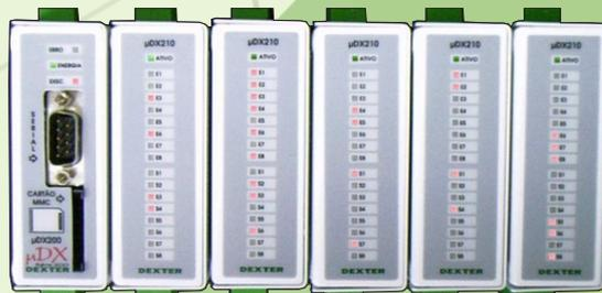
CPU e Expansões montados em trilho DIN.
