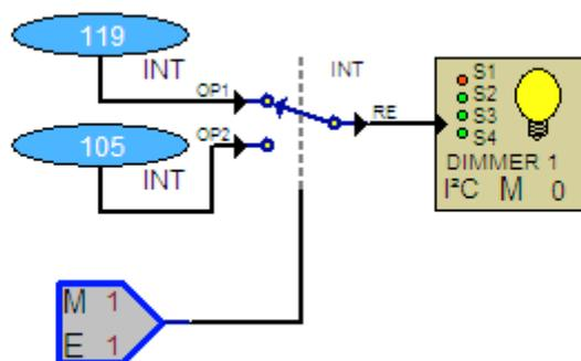
Ao energizar a entrada E1 da Expansão  $\mu$ DX210 o valor na entrada do primeiro canal do Mini-Dimmer comuta de 105 (saída desligada) para 119 (saída ligada no máximo), sem a rampa de transição característica do Mini-Dimmer.
