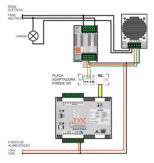
Entretanto, versões antigas de Mini-Dimmer não permitem esta conexão. Isso porque, nestes casos, não há o acionamento do ventilador do Dimmer de Potência. Então, convém testar se ocorre acionamento do ventilador quando o Dimmer de Potência é acionado via Mini-Dimmer. Se isso não ocorrer é preciso remeter Dimmer e Mini-Dimmer para a Dexter efetuar as atualizações de software necessárias. Este processo é gratuito, e o cliente apenas terá despesas de remessa do material.
