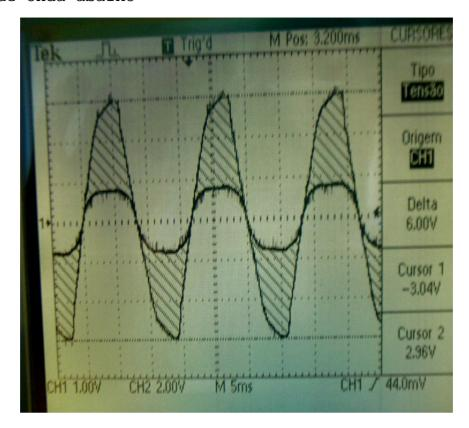
Agora a tensão pico a pico vai a 6Vpp\*151 = 906Vpp, ou seja, 453Vp. Daí resulta que a tensão RMS é de 453/1,4142 = 320Vca. Ou seja, a tensão RMS excede largamente o limite dos dimmers (até 250Vca), devido aos picos gerados pelo reator eletrônico. Além disso, submete os equipamentos a constantes picos de alta amplitude e freqüência. Abaixo os picos com uma varredura no scope mais rápida:
