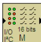
O novo bloco lê a variável inteira (16 bits), sendo que o byte superior deve ser idêntico ao byte inferior para validar o dado lido. Com isso, obtêm-se segurança na leitura de dados dos Keypads, evitando dados errôneos ocasionados por ruídos elétricos e outras interferências. Recomenda-se enfaticamente o uso deste novo bloco, principalmente em redes I<sup>2</sup>C extensas.
