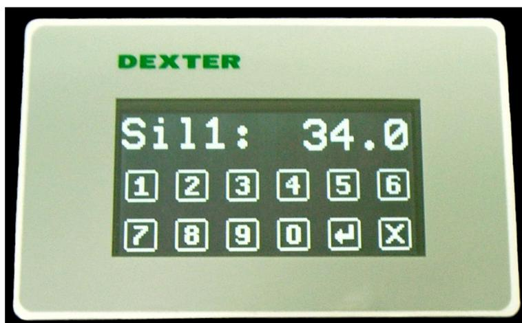
**Atenção:** A Interface Homem/Máquina μDX220 opera apenas com controlador μDX201. Sua conexão em controlador μDX200 não a danifica, mas a manterá inoperante. Os blocos para acionamento da IHM somente estão disponíveis em controlador μDX201.
