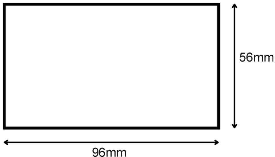
Acompanha a IHM uma moldura de material flexível, auto-colante, para permitir a vedação entre o painel e a IHM. O desenho a seguir ilustra como a IHM  $\mu$ DX220 é fixada a um painel no qual previamente foi efetuado um rasgo de 96 x 56 mm. Evidentemente é preciso dar acabamento às arestas do rasgo,
