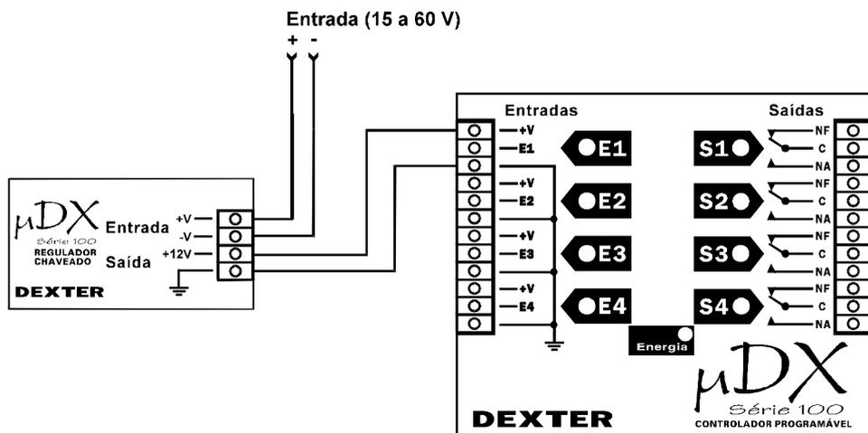
A entrada do regulador chaveado deve ser conectada a uma fonte de tensão contínua de 15 a 60 Vdc.
