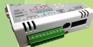
Conector das entradas digitais, com pinos para pilhas de referência externo, alimentação 12V por fios e aterramento. Conector de alimentação para a fonte 12V que acompanha o equipamento. Conector para expansões de entradas e saídas digitais μDX110 ou Expansão μDX100.
