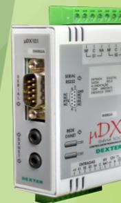
Parte frontal com LED indicador de energia, porta Serial RS232 e conectores P2 para rede DXNET.
