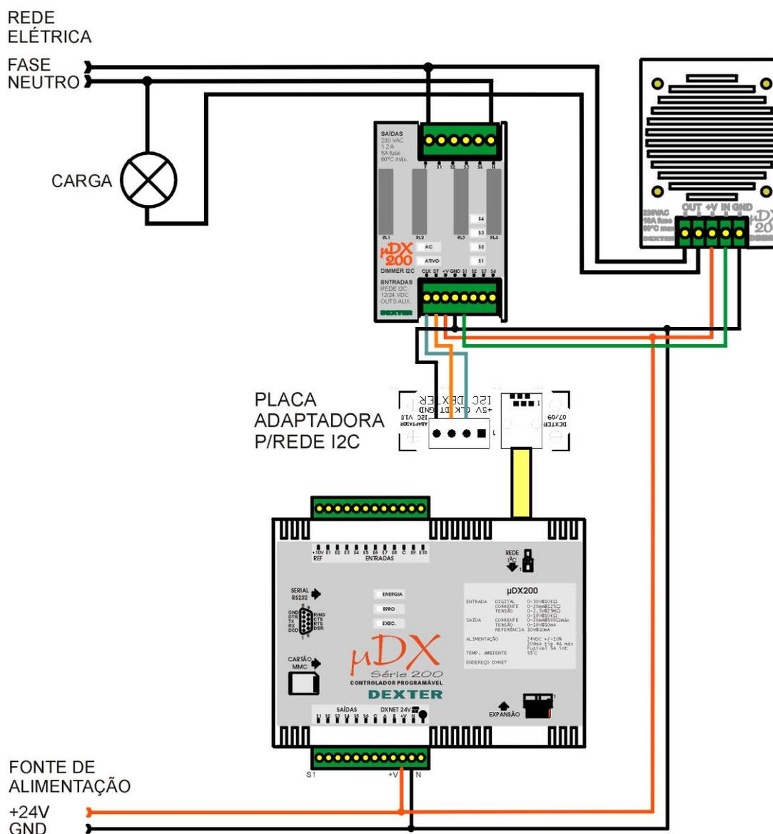
Além de permitir acionar Dimmers de Potência (desde que compatíveis – vide documento *Nota03\_Dimmer.pdf*), as saídas auxiliares do Mini-Dimmer também podem ser conectadas à placas de Saída Analógica. Isso permite gerar um sinal analógico 0-5V ou 0-10V proporcional ao nível de iluminação programado no Mini-Dimmer. A principal aplicação é para controle de dimmers para lâmpadas fluorescentes, cuja entrada de controle é um sinal analógico 0-5V ou 0-10V.
