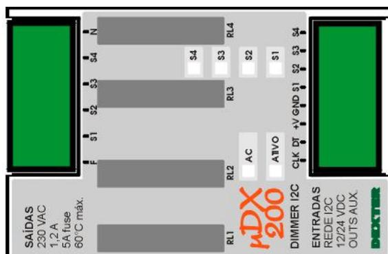
O Dimmer I<sup>2</sup>C possui dois conectores de engate rápido, um para os sinais de rede I<sup>2</sup>C, alimentação elétrica do Dimmer (12 ou 24Vdc) e saídas auxiliares; e outro para o acionamento de potência.
