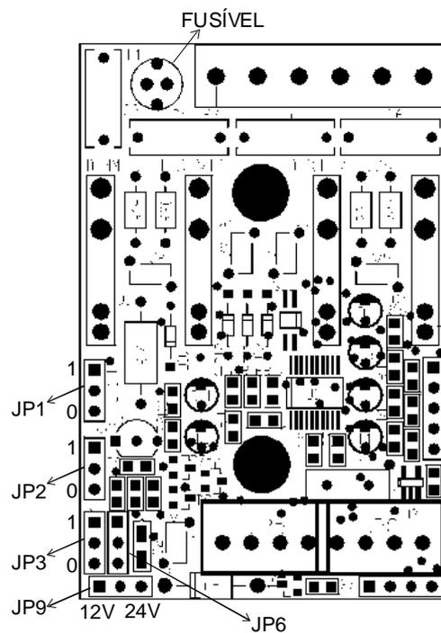
Os jumpers JP1, JP2 e JP3 da placa do Dimmer indicam o endereço do mesmo. Se o jumper estiver ligado entre o pino central (pino 2) e o pino superior do conector (pino 1) o jumper estará em nível 1 (um). Já se o jumper estiver conectado entre o pino central (pino 2) e o pino inferior do conector (pino 3) o jumper estará em nível 0 (zero). Os 8 endereços possíveis para o Dimmer I<sup>2</sup>C são determinados pela combinação de JP1, JP2 e JP3:
