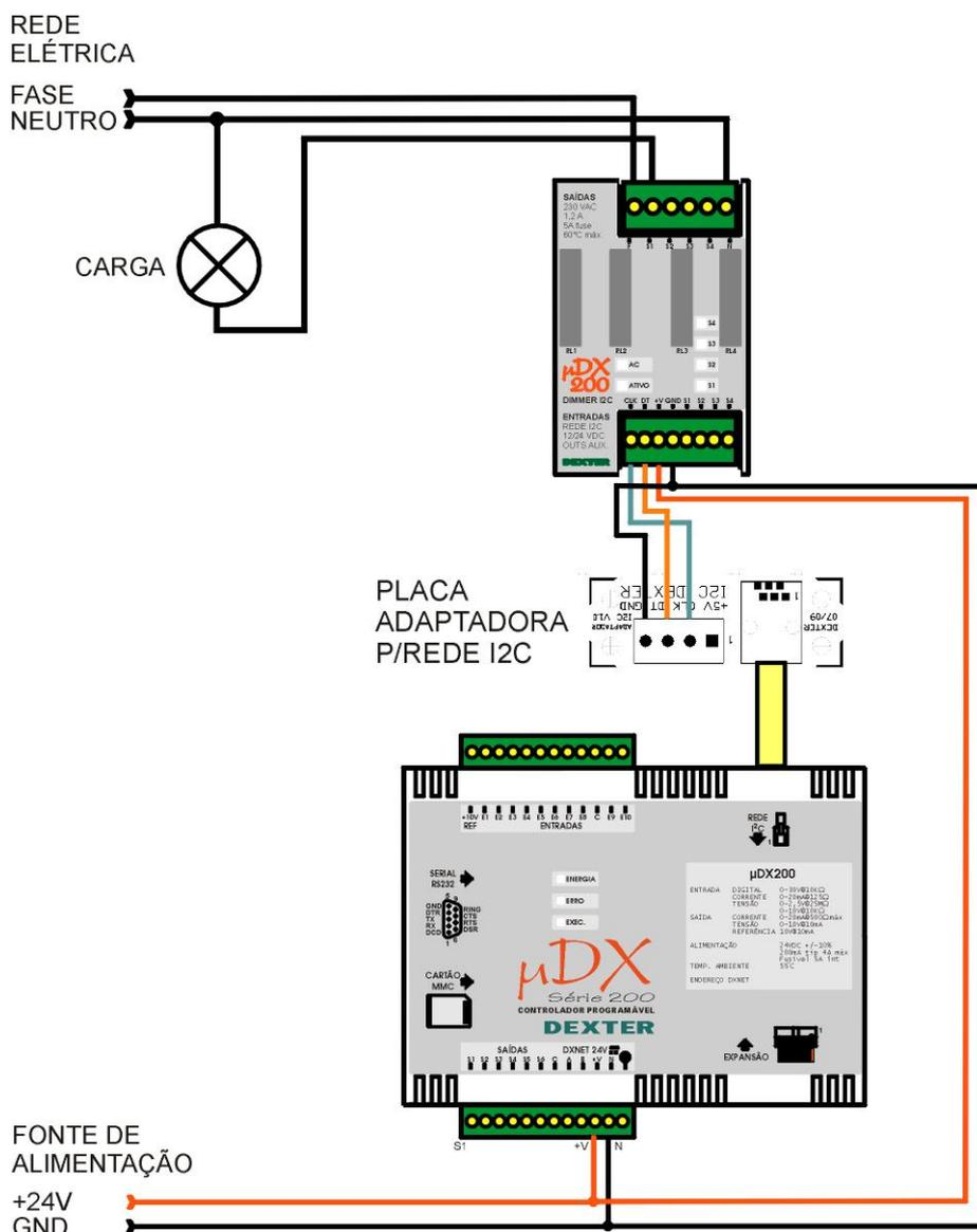
**Atenção:** Módulos Dimmer I2C versão 2.2 ou superiores permitem conexão tanto em rede elétrica de 60Hz (como a do Brasil) como em redes de 50Hz (presentes em alguns países da América Latina e Europa). O próprio equipamento se ajusta à rede elétrica, não sendo necessária nenhuma providência por parte do instalador. Versões antigas de Dimmer I2C podem ser atualizadas. Para isso basta que sejam enviadas à Dexter. Não há custo neste serviço, exceto o frete dos dispositivos.
