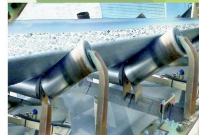
Balança integradora do tipo esteira.
