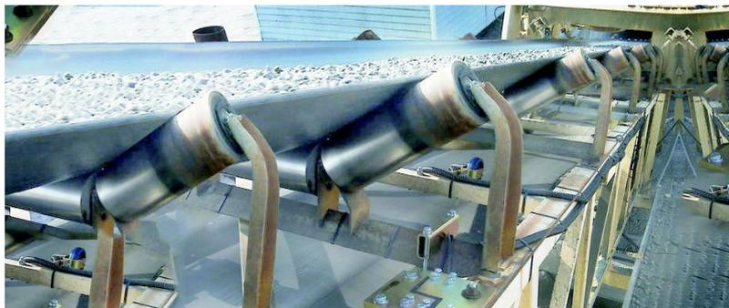
A Balança Integradora  $\mu$ DX201 mede e controla a vazão em esteiras transportadoras. As aplicações na indústria e construção civil são inúmeras. Por exemplo, na formulação de concreto em grandes obras, como hidrelétricas; carregamento de grãos em navios; formulações diversas para indústria química e alimentícia; etc.
