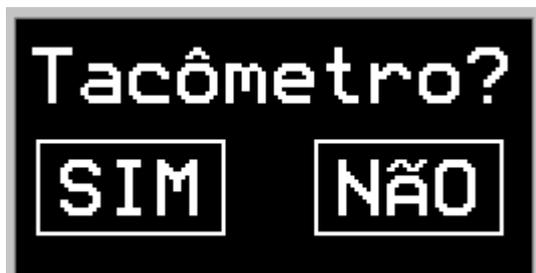
Se for especificado que não existe tacômetro a balança permite digitar a velocidade fixa da esteira, em metros por minuto:
