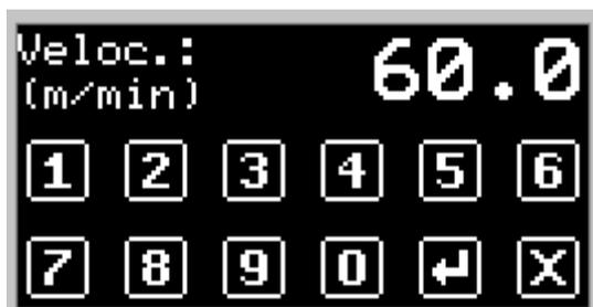
Se for especificada a existência de tacômetro surgem duas opções de calibração do tacômetro, por amostragem ou matemática. A calibração por amostragem permite especificar a velocidade de esteira atual em metros por minuto e associa o número de pulsos recebidos na entrada E9 com essa velocidade. Já na calibração matemática do tacômetro deve-se especificar quantos pulsos o tacômetro fornece por metro de deslocamento da esteira.
