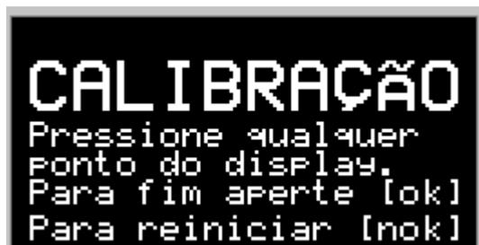
**Observação:** Caso seja necessário recalibrar o sensor touchscreen do display basta energizar o controlador  $\mu$ DX201 mantendo o display pressionado por cerca de 6 segundos.
