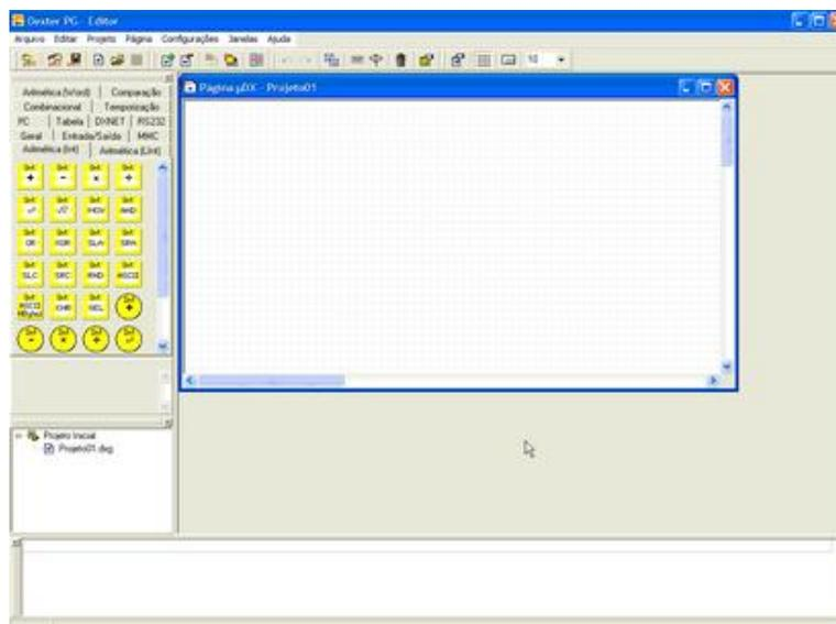
Podemos a partir deste ponto iniciar o desenvolvimento de um programa aplicativo. Digamos um programa bem simples, que ligue a saída S1 do módulo M1 de Expansão de Entradas/Saídas  $\mu$ DX210 sempre que as entradas E1 e E2 deste módulo forem energizadas simultaneamente. Para isso pode-se usar chaves NA (normalmente aberta), ou a função booleana AND. Elaborando o programa via chaves NA, selecione a família de blocos Geral e pressione a tecla esquerda do mouse sobre o bloco Chave NA.
