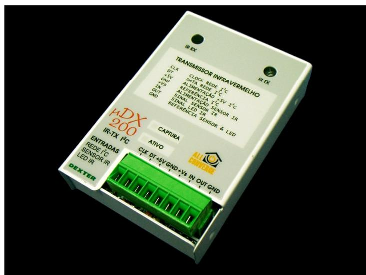
O Transmissor Infravermelho I<sup>2</sup>C possui um conector de engate rápido com os sinais de rede I<sup>2</sup>C e sinais para instalação de sensor e transmissor infravermelhos remotos. No painel frontal existe sensor infravermelho para o aprendizado de comandos, e transmissor infravermelho para sua reprodução. É possível a conexão de até 8 Transmissores Infravermelhos por CLP.
