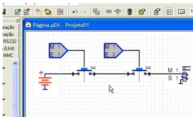
Agora basta compilar o programa utilizando o Compilador PG e transmití-lo para o µDX200 via porta serial para que o controlador passe a se comportar como descrito acima. A seguir é mostrada a tela com o Compilador PG e o Editor PG ao fundo. Note que o Compilador PG não só permite transmitir o programa para o CLP, como também permite monitorar ou modificar o valor de variáveis e nodos do programa aplicativo.
