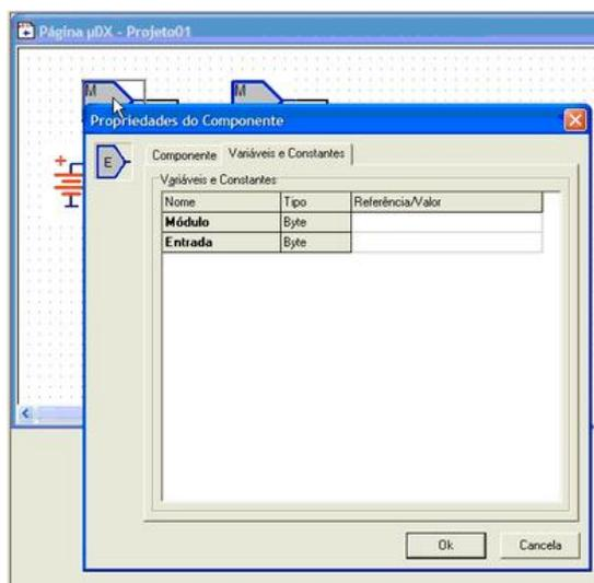
Edite os parâmetros destes blocos, selecionando todos com Módulo 1 (ou seja, iremos usar a primeira Expansão de Entradas/Saídas µDX210) e Entrada 1 e 2, e por fim Saída 1. Está pronto o programa! Note que a Energia só alcançará a Saída S1 se as duas entradas, E1 e E2, forem energizadas simultaneamente (fechando as chaves NA).
