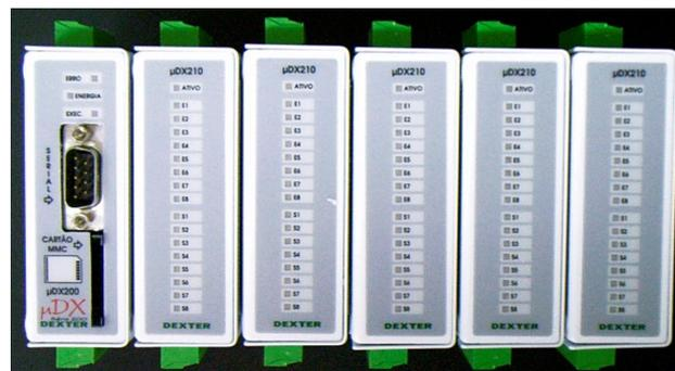
**Nota:** não se recomenda a fixação de  $\mu$ DX200s ou  $\mu$ DX210s em posições diferentes das descritas acima (posição vertical), em função de comprometer o arrefecimento dos dispositivos.
